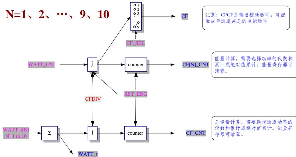
提供 10 通道的电能脉冲累计。原理是每个通道的有功功率通过一段时间的积分，可获得这段时间有功能量，并进一步把能量转化成对应频率校验脉冲 CF，用电多，CF 频率就快，用电少，CF 频率就慢。
