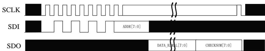
当 BL0910 处于通信模式时, 帧识别字节 {0x82}, 表示下一个数据传送操作是读出。然后紧跟的字节是待读出目标寄存器的地址。BL0910 在 SCLK 的上升沿开始移出寄存器中的数据。寄存器数据的所有其余位在随后的 SCLK 上升沿被移出。因此, 在下降沿, 外部设备可以对 SPI 的输出数据进行采样操作。一旦读出操作结束, 串行接口便重新进入通信模式。这时, DOUT 逻辑输出在最后一个 SCLK 信号的下降沿进入高阻状态。
