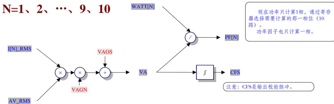
电流和电压有效值进行数字乘法，然后依顺序经过增益和偏差校准可以获得无功功率信号。经过积分后获得无功能量脉冲累计。有功功率除以视在功率可以获得功率因子。
