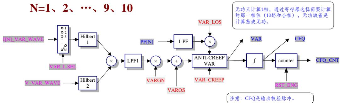
电流和电压波形通过 Hilbert 滤波器后，再进行数字乘法，然后依顺序经过低通滤波器、增益和偏差校准、防潜动判断及平均处理后可以获得无功功率信号。经过积分后获得无功能量脉冲累计。
