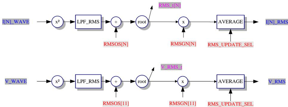
每个通道的原始波形，经过平方电路(X<sup>2</sup>)、有效值低通滤波器(LPF\_RMS)、开根电路(ROOT)，得到有效值的瞬时值 RMS<sub>t</sub>，再经过平均得到每个通道的平均值 I[N]<sub>RMS</sub> 和 V<sub>RMS</sub>。
