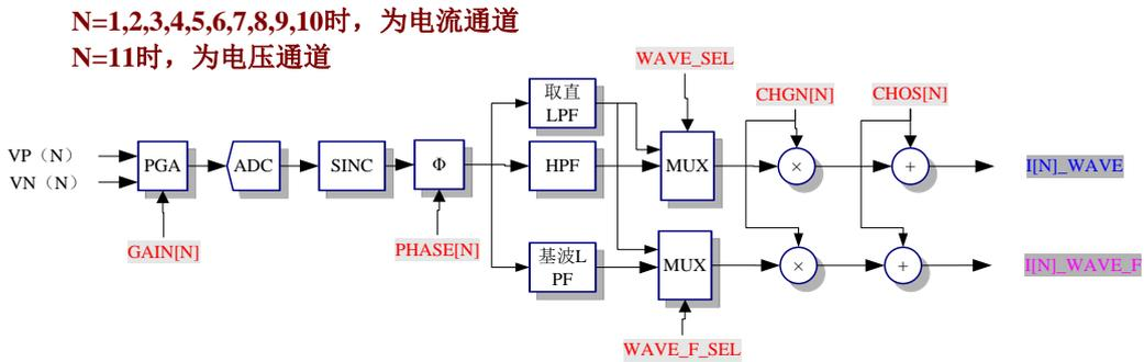
共有 11 路相同结构的高精度的 ADC，采用双端差分信号输入：第 N 路电流通道输入的正负电压信号为 VP[N]和 VN[N]。
