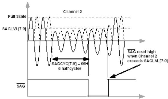
如上图所示，当电压有效值小于跌落电压阈值寄存器（SAGLVL）中设定的阈值并且跌落时间超过跌落线周期寄存器（SAGCYC）中的设定时间（图示为超过第 6 个半周期后，SAGCYC[11:0]=06H），线电压跌落事件通过设置中断状态 STATUS1 寄存器中的 SAG 标志位来记录下来。
