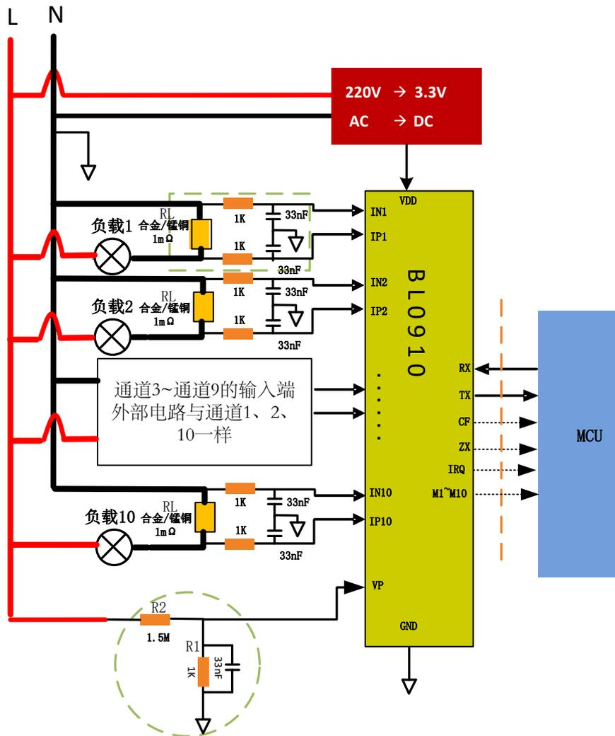
对于 1U10I 应用，每个电流通道外部线路图都一样，电压通道需要信号分压。
