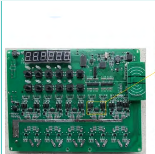
10路电动自行车充电桩主板（0939） UART总线通信，只占用2个光耦
